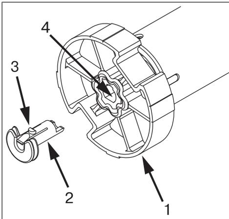
Stecken Sie den Mitnehmer (1) auf die Abtriebswelle des Rohrantriebes auf. Die Einschubposition der Mitnehmersicherung (2) ist durch seine Form vorgegeben. Beim Einschieben der Mitnehmersicherung (2) in die Rastbohrung (4) achten Sie bitte auf das Einrasten der Rastnase (3). Dies ist durch ein Klicken hörbar. Überprüfen Sie den festen Sitz der Sicherung durch Ziehen am Mitnehmer (1).
