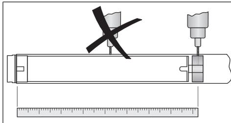
Um den Antrieb gegen axiales Verschieben zu sichern, empfehlen wir den Mitnehmer mit der Welle zu verschrauben.
