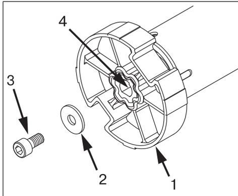
Stecken Sie den Mitnehmer (1) auf die Abtriebswelle des Rohrantriebes auf. Verwenden Sie zur Montage eine Schraube M6x12 (3) mit entsprechender Unterlegscheibe (2) und geeigneter Schraubensicherung. Gewindebohrung (4)
